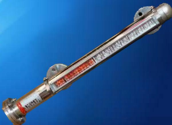
Магнитные указатели для измерения уровней жидкости в резервуаре могут устанавливаться различными способами. При увеличении или уменьшении объема жидкости в резервуаре, поднимается и опускается поплавков, находящийся в байпасной измерительной камере, по принципу сообщающихся сосудов.
